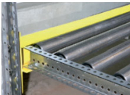
Überschubsicherung mittels Winkeltraverse
