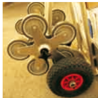
Les roues caoutchoutées garantissent une bonne adhérence. Leur dimensionnement est adapté à la hauteur des marches des bâtiments.
