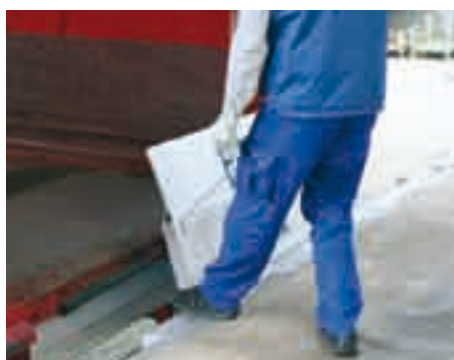
...débloquer le pont avec le pied et le mettre en place...
