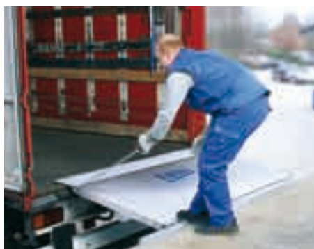
...mettre le pont de liaison en place...
