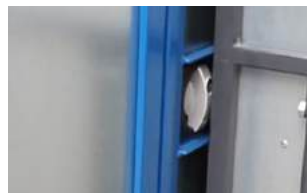
DREHSCHLOSS BÜNDIG MIT GRUNDRAHMEN
