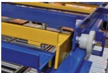
Systèmes Pushfix – des chariots au lieu des rouleaux dans le rayonnage « Push Back »
