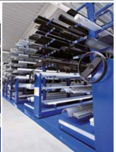
Rayonnages cantilever mobiles META MULTIBLOC : les deux rangées du haut montrent la **variante lourde** avec entraînement électrique et la rangée du bas montre la **variante légère** avec l'entraînement manuel
