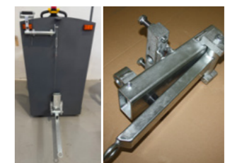
NACHHER: Zugfahrzeug mit Deichsel
