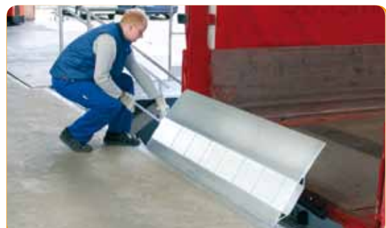
In der senkrechten Parkposition ist die Brücke automatisch gesichert – mit einem Bedienhebel wird sie entriegelt und bequem herabgelassen.
