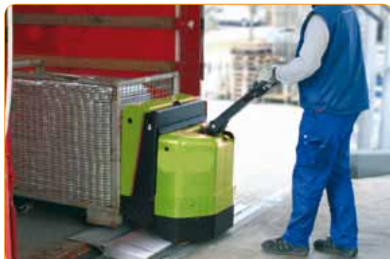
Perfekte Logistiklösungen: Damit die Anbaubrücken in die optimale Verladeposition gebracht werden können, sind sie mit Kugellagern und Scharnieren bestückt.
