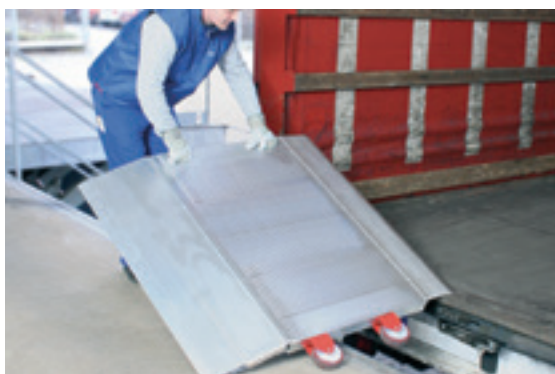
Das Gummiprofil an der Auflagekante sichert die Verladebrücke gegen ein Verrutschen und dient der Lärmdämmung. Bis 1500 mm Länge sind Staplertaschen als Zubehör möglich.
