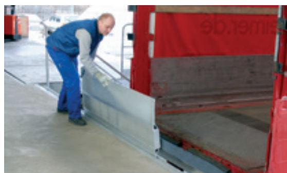
Schnell einsatzbereit: Diese Anbaubrücke ist in die an der Rampe angeschraubte oder angeschweisste Profilschiene eingehängt und seitenverschiebbar
